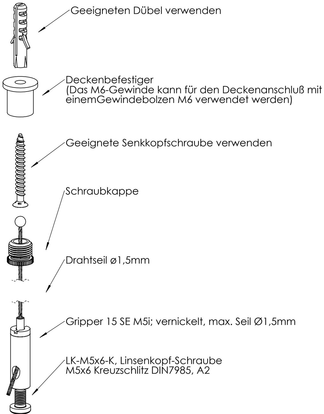
**Der Deckenbefestiger wird mit einem geeigneten Dübel und einer Schraube an der Decke angebracht. Die Deckenbefestiger haben auf ihrer Kopfseite ein M6 Innengewinde und können auch mit einem geeigneten Gewindebolzen befestigt werden. Das Drahtseil in die Schraubkappe einfädeln und in die Schraubkappe in den Deckenbefestiger einschrauben.**
